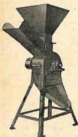
O Moinho a Martelos **Cordeiro** foi idealizado para ser usado em granjas, sítios e pequenas fazendas. Produz fubá de milho fino e grosso — Quirera de milho e arroz — Desintegra o milho com palha e sabugo. O Moinho de Martelos **Cordeiro** é inteiramente metálico e equipado com 14 martelos de ferro cimentado. Capacidade de produção: 30 a 220 kg por hora, de acôrdo com o material a ser moído.
