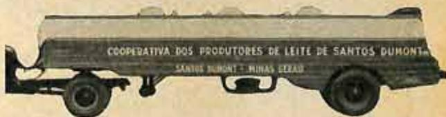
**Carro tanque istérmico com capacidade até 20.000 litros** **TRIVELLATO**
