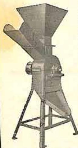
O Moinho a Martelos **Cordeiro** foi idealizado para ser usado em granjas, sítios e pequenas fazendas. Produz fubá de milho fino e grosso — Quirera de milho e arroz — Desintegra o milho com palha e sabugo. O Moinho de Martelos **Cordeiro** é inteiramente metálico e equipado com 14 martelos de ferro cimentado. Capacidade de produção: 30 a 220 kg por hora, de acordo com o material a ser moído.
