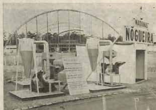
Irmãos Nogueira, Importação, Indústria e Comércio de Máquinas Agrícolas e Motores, estabelecidos em Itapira, na rua 15 de Novembro, Estado de São Paulo, 781, compareceram na Feira com o desintegrador, picador e moedor de forragem uma linha de aparelhos destinada a grande êxito. Inovação em máquinas de cortar e moer, trabalham milho com palha e sabugo, palha de feijão, palha de arroz, todas as sementes e cascas de cereais. Fazem fubá fino e médio, grosso e mimoso. Cortam cana, capina e tubérculos, leguminosas, etc.
