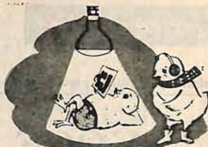
Desenhos mostrando como funciona o aquecimento com lâmpadas de infra-vermelho. Os raios caloríferos se projetam pelo cone das lâmpadas deflectidos pelo revestimento interno, prateado na parte superior das lâmpadas, que funcionam como verdadeiras câmpanulas.
