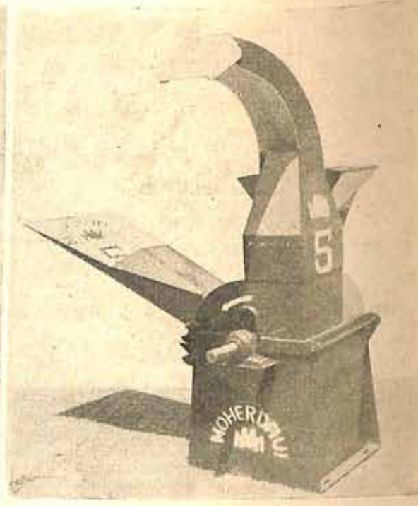
Conjugada tipo MM-5 Produção: 500 kg/h (secos) e 5.000 kg/h (verdes) Rotação: 2.500 R.P.M. Força necessária: 10 H.P.
