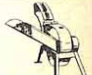
Cortadeira de Forragens. Cana, capim, tuberculos etc. 1, 3, 6 e 9 toneladas horárias.
