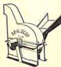
Picadeira de cana: elétrica, a gasolina ou a óleo cru.
