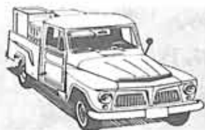
O Willys F-75 é resistente e transporta fácil 750 kg de carga na sua caçamba. Tem 3 ou 4 marchas sincronizadas, com TRABAL (diferencial auto-blocante) e tração nas 4 rodas.
