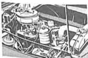
O motor do Willys F-75 tem 6 cilindros em linha e 90 HP; é o mais econômico de sua classe. Faz mais de 6 km com 1 litro de gasolina. Você pode escolher também motores de 110 e 130 HP.
