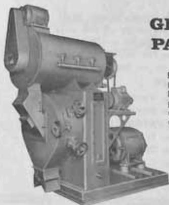
Pressa rotativa para ração granulada. Totalmente equipada. Produção desde 1/2 t até 10 t por hora. Construção robusta em aço, dispositivos de segurança, fácil manejo.
