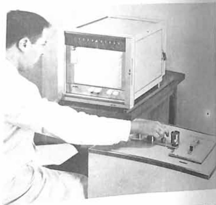
Fig. 2 Durante o congelamento no congelador biológico EFT-500 a velocidade de esfriamento pode ser controlada com a ajuda de um registrador potenciométrico PHILIPS.
