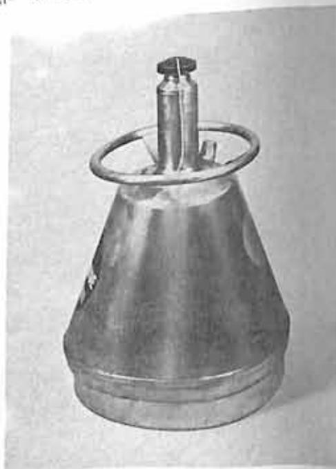
Fig. 4 Vaso dewar para nitrogênio IC 25, com capacidade para 25 litros produzidos pela AIR LIQUIDE.
