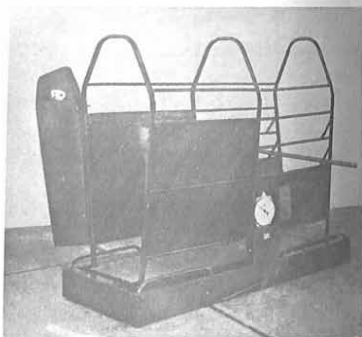
Balança com alças para ser levantada sobre carreta.
