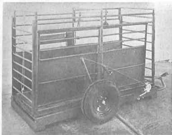
Balança com rodas e engate para ser rebocada por trator ou carreta.
