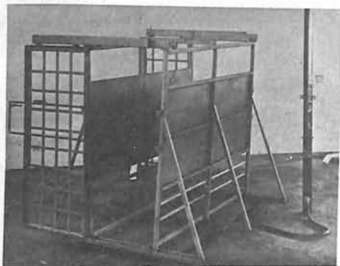
Portinhola corredeira, fácil de manusear. Note-se o princípio de operação hidráulica, com leitura do peso através da coluna líquida à direita.
