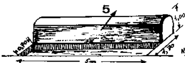
FOSSO E TALUDE
