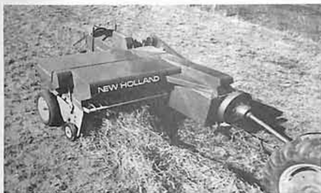
A enfardadeira recolhe o feno curto e fino, produzindo fardos compactos e firmemente amarrados para serem oferecidos ao gado no período de inverno ou secas.
