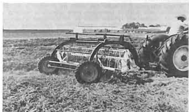
O ancinho revolve suavemente a forragem cortada fazendo com que seja produzido um feno limpo de impurezas, pois os dedos revolvedores não raspam o solo.
