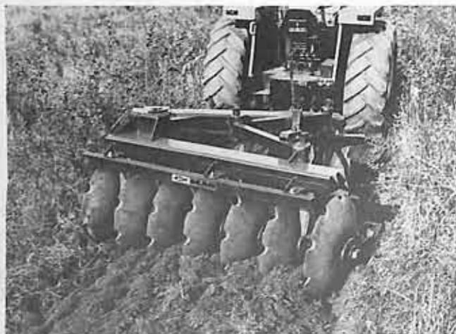
Para tratores de pneus e tratores de esteira. O trabalho realizado por uma grade Tubarão na soqueira de cana e cerrados dispensa o uso de arado. A grade Tubarão funciona sobre mancais com rolamentos cônicos, protegidos por retentores duplos para evitar penetração de terra ou umidade. O sistema hidráulico de abertura e fechamento do conjunto é feito diretamente pelo próprio tratorista. A grade de arrasto Tubarão é fabricada pela Baldan Implementos Agrícola S/A., de Matão — SP.
