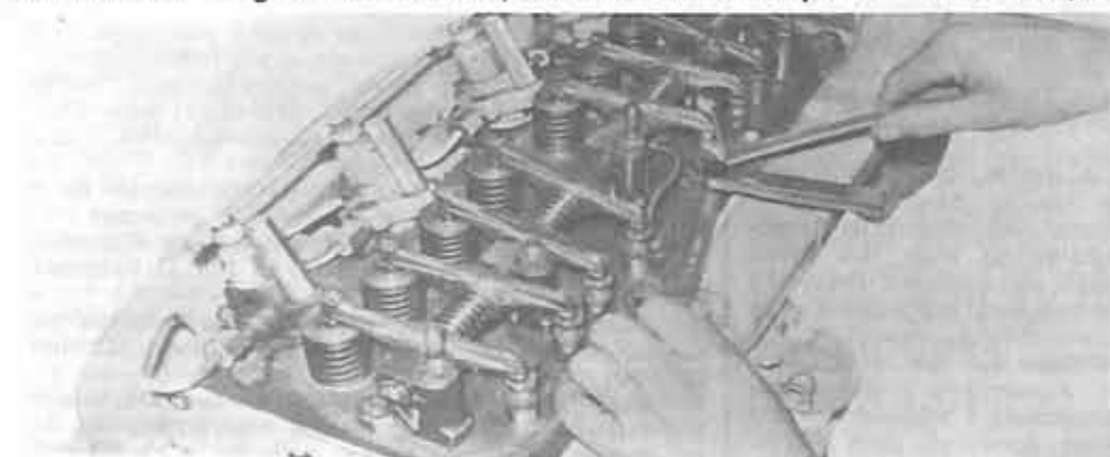
Reajustagem da folga das válvulas.
