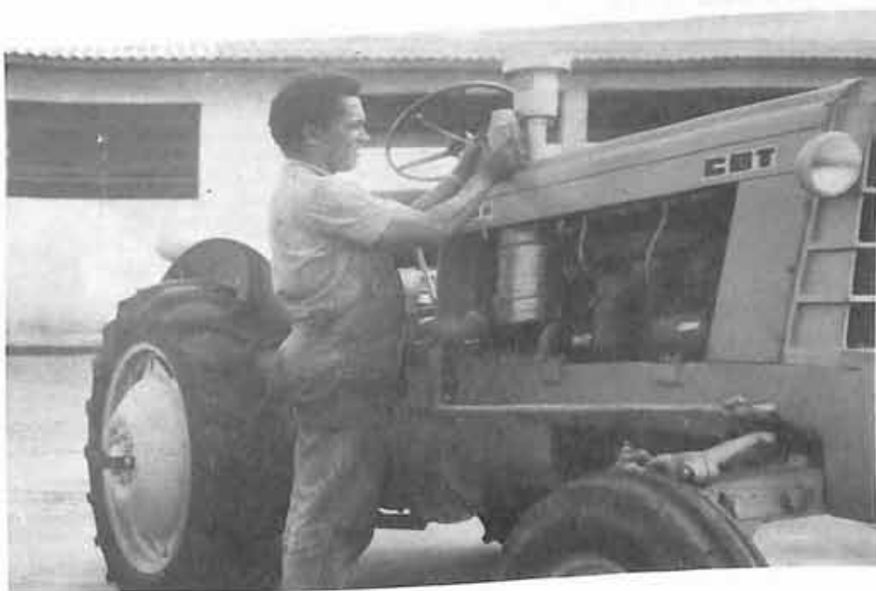
Limpeza do pré-purificador de ar.
