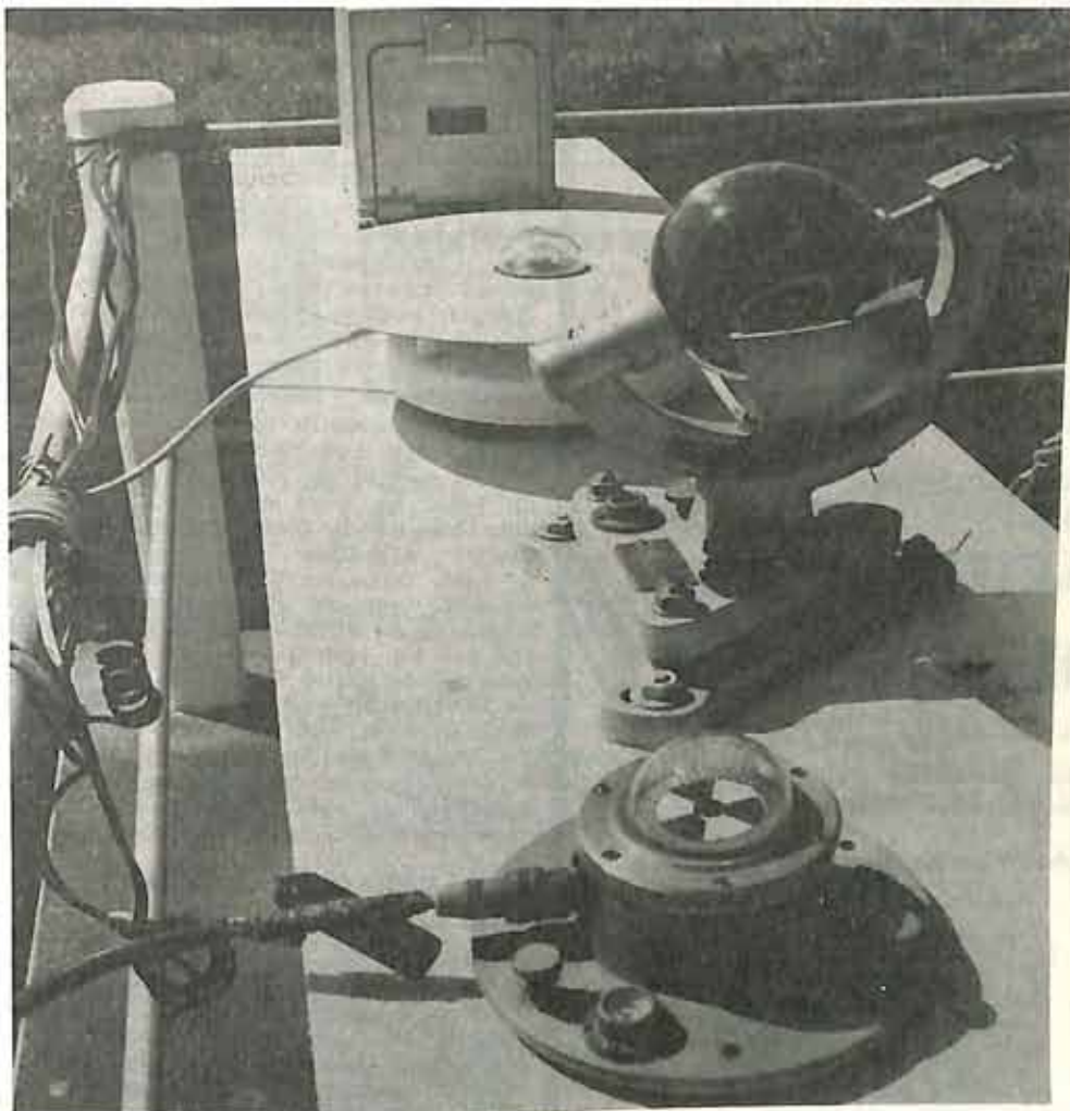
Aparelho para medir a radiação solar.
