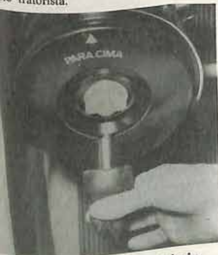
No filtro de ar, comprimir com os dedos a válvula para eliminar a poeira.
