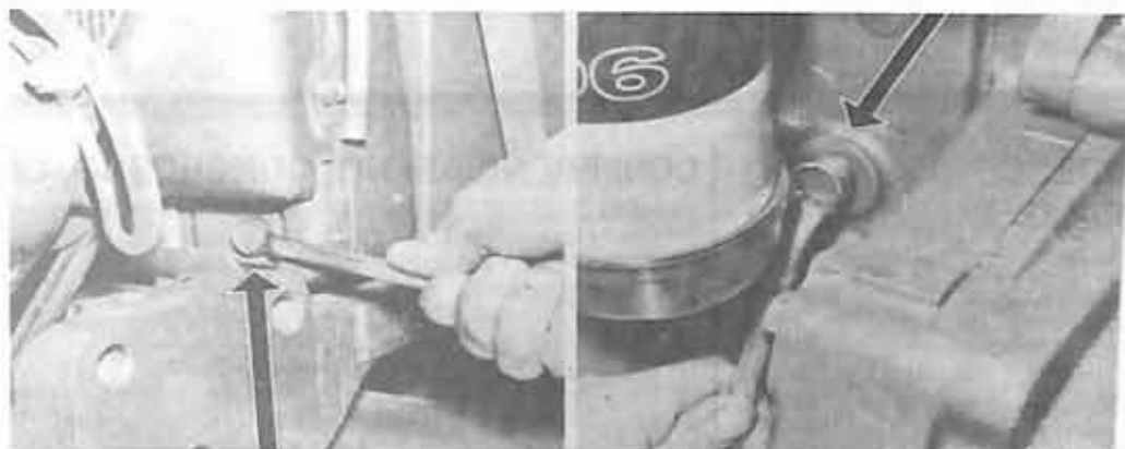
Para drenar a água do radiador, remover a sua tampa e abrir dois bujões.
