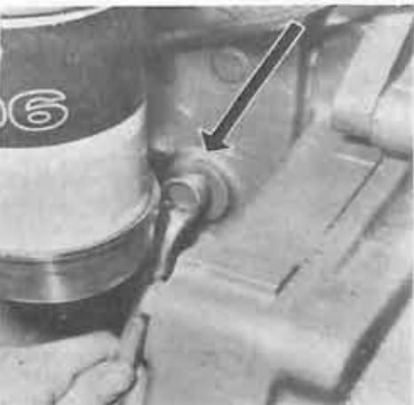
Drene a água do radiador (esquerda) e do bloco motor (direita).
