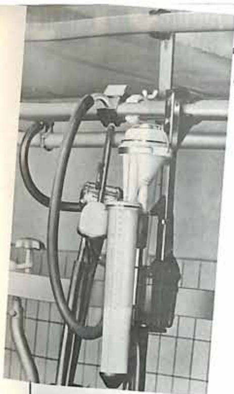
Indicador de final da ordenha e medidor do leite.
