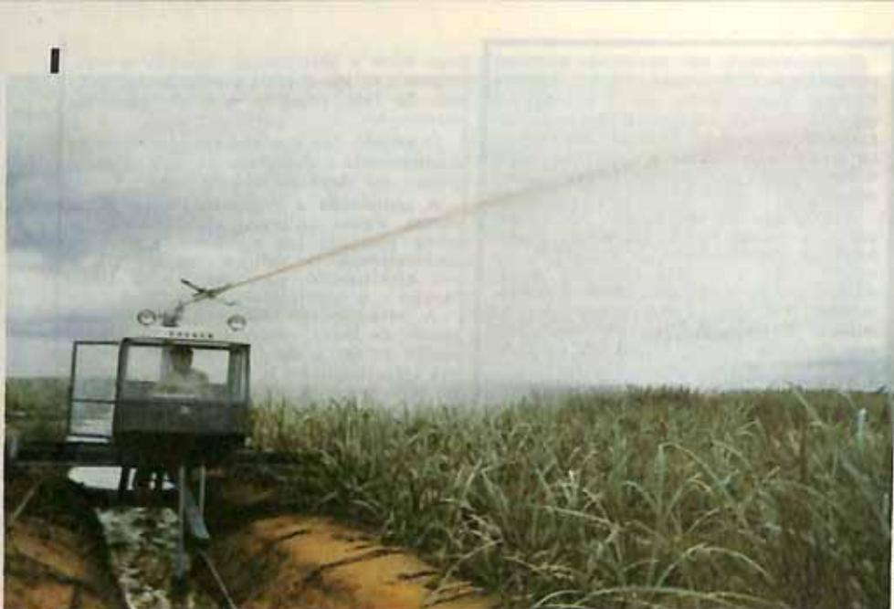
**Em ação, um conjunto de montagem direta com canhão hidráulico automotriz.**
