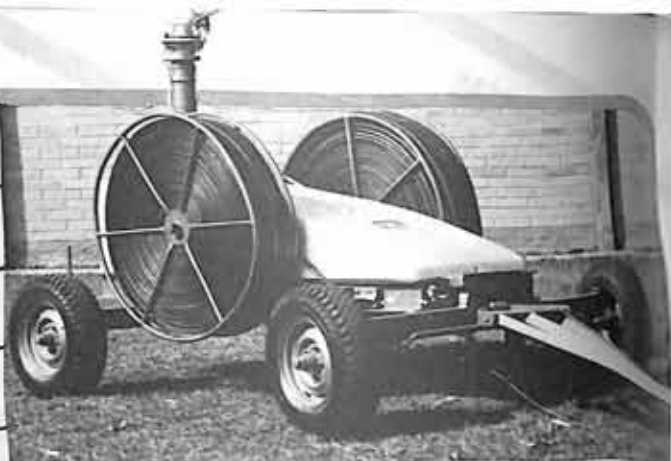
Acima, o conjunto auto-propelido turbinado ao todo, montagem direta do aspersor, ambos fornecidos pela empresa.
