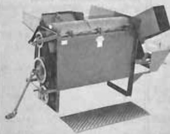
Batedeira de Cereais Modelo BC-40. Ba- te, ventila e ensaca. Produção: Arroz - 15 a 25 sacos 60 kg/ho- ra; Feijão - 15 a 20 sacos 60 kg/hora.
