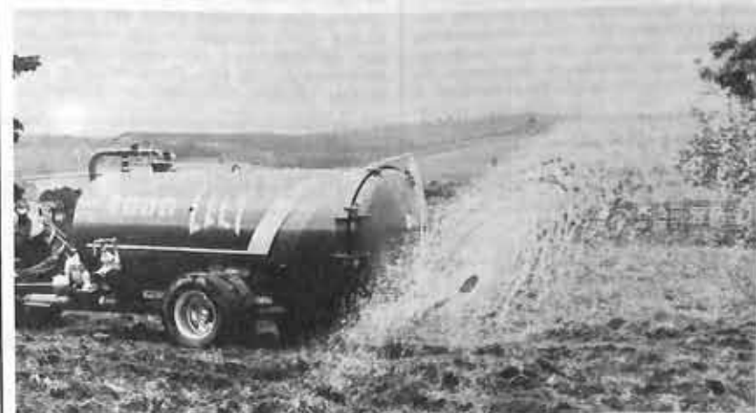
Distribuidor de adubo orgânico líquido, aplicando chorume.
