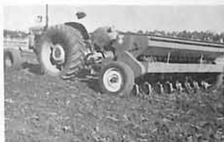
Aqui, um modelo de linhas, usado também para a adubação, quando do plantio.
