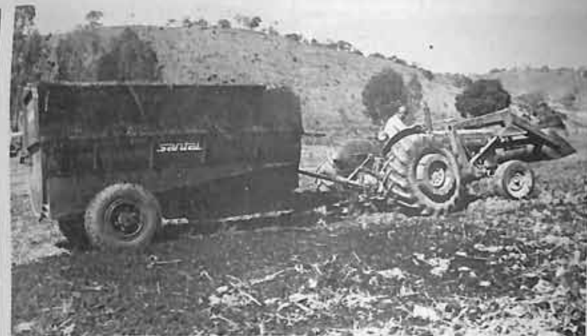
O distribuidor de adubo orgânico sólido tem em seu interior um eixo rotativo provido de aletas, para espalhar.
