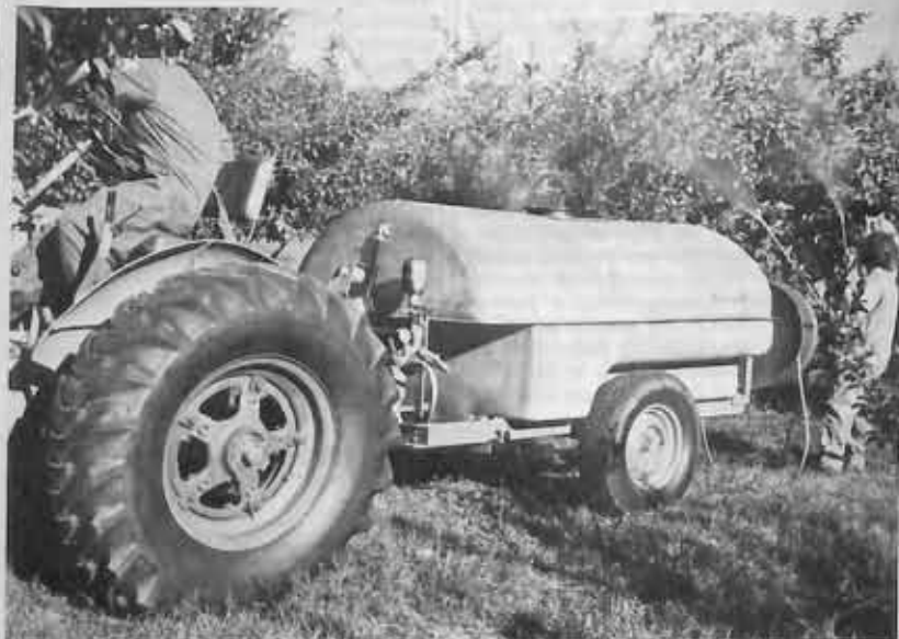
Pulverizador tracionado e acionado pelo trator, usado em pulverização, com mangueiras.
