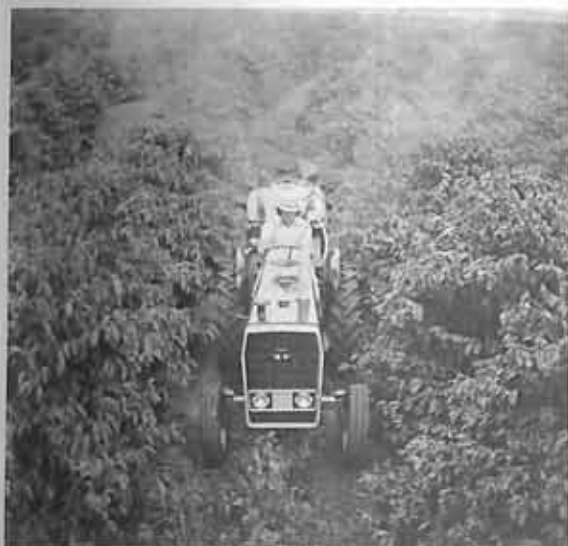
Pulverizador com turbina, em operações nas ruas de um cafezal.
