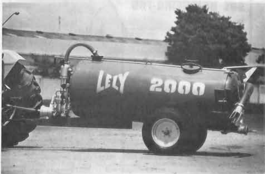
Distribuidor de esterco líquido montado em carreta com rodado duplo.
