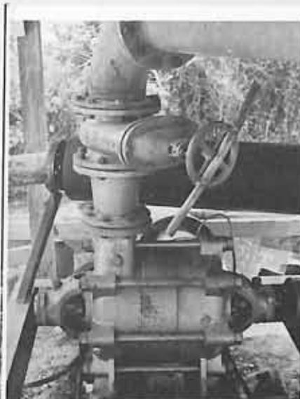
**Bomba centrífuga de três estágios usada em irrigação.**
