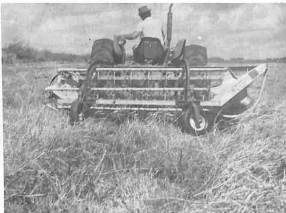
Ancinhos tipo molinete usado no enleiramento
