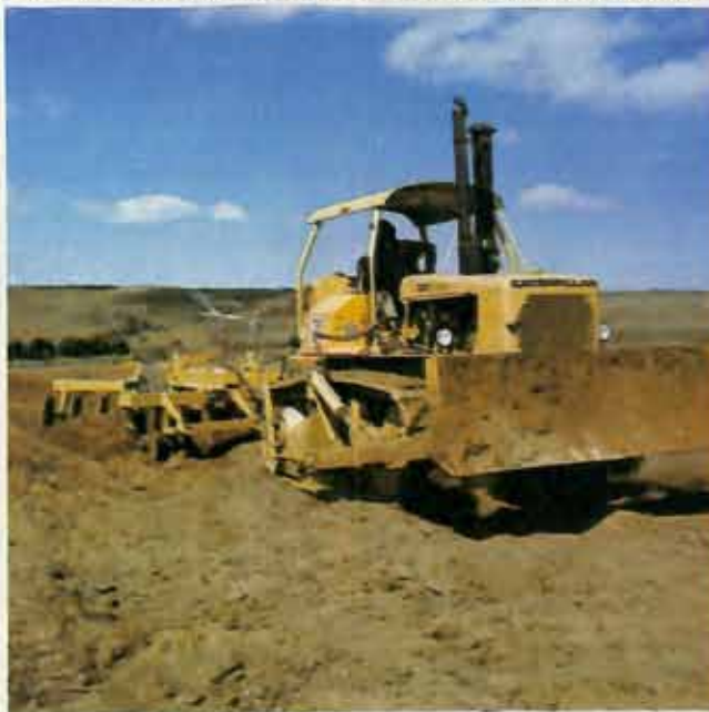
Gradagem pesada com 4,10 Metros de largura de corte e 30 cm de profundidade.
