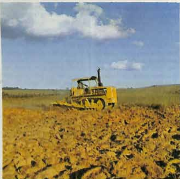
Trator de esteiras D6D SA subsolando pastagens após a gradagem pesada.
