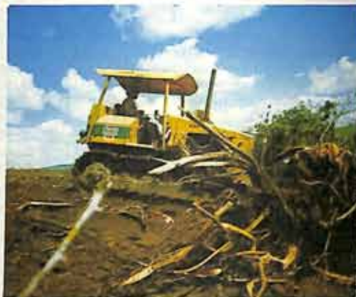
Operação de gradagem pesada após o desmatamento.
