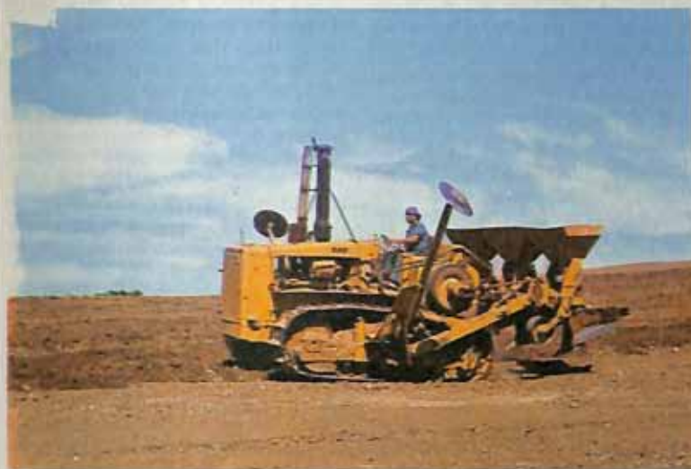
Trator equipado com sulcador adensador (3 linhas).
