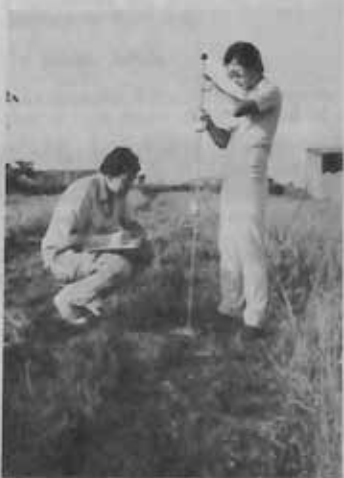
Determinação da compactação com penetrômetro de impacto.
