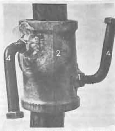
Fig. 5 C. Esta parte do suporte é feita por um ferreiro e soldada à porca (1) por uma manga (2). O braço pode então ser levantado ou abaixado mediante a manga e apertando a cavilha (4).
