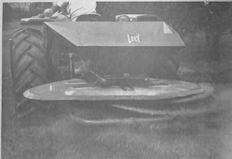
Distribuição centrífuga por meio de discos.
