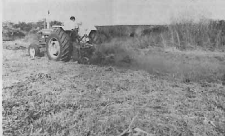
Destruição da soqueira e incorporação das sementes em uma única passada.
