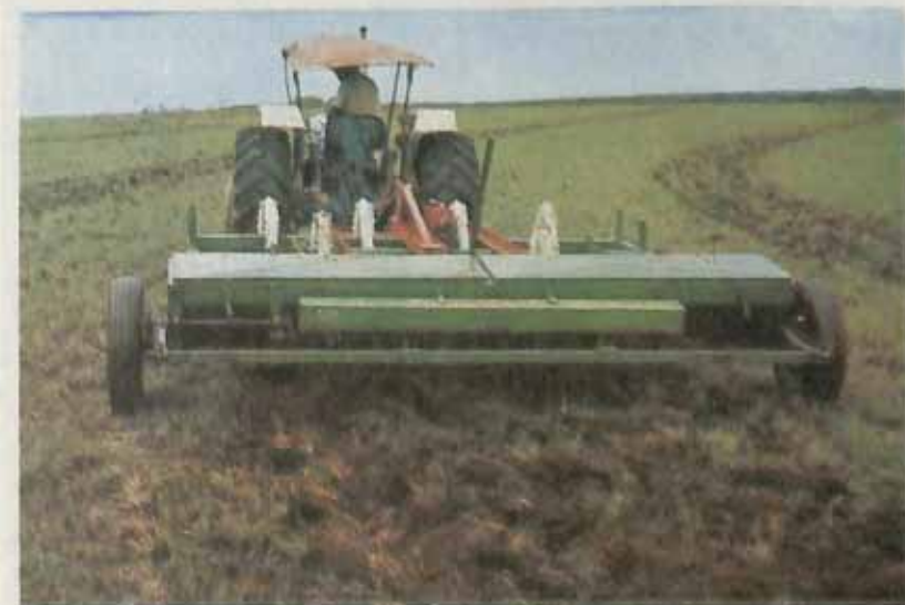
Plantadeira/adubadeira combinada: Um adequado método econômico e ecológico para a formação de pastagens.
