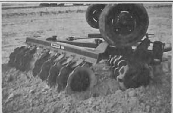
Grade aradora de arrasto com pneus para transporte acionados mecanicamente em operação.
