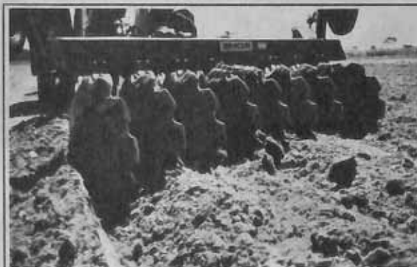
Detalhe da localização dos discos atrás dos porta-discos
