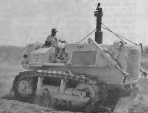
Em função do volume de serviço a ser executado tracionando as grades, o D6D Caterpillar tem sido pouco utilizado em trabalho de lâmina. Mas o simples fato de poder contar com um trator agrícola que trabalha com lâmina, com índices mínimos de compactação e com alta disponibilidade mecânica, representa a certeza de que a ISAPA não vai ficar apenas nos 4.000 hectares.
