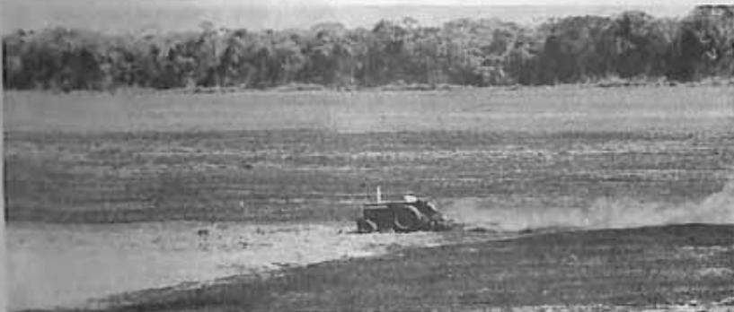
Enxada rotativa incorporando matéria orgânica, substituindo o arado, grade destorroadora e grade niveladora.
