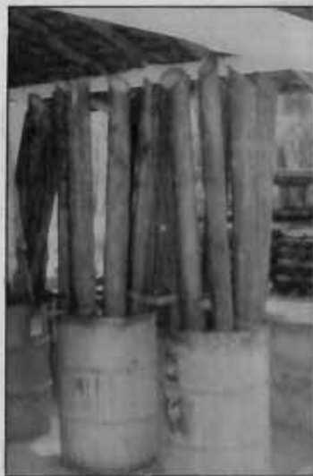
Mourões de eucalipto em tratamento por 08 dias com a base dentro da solução. Processo substituição de seiva.
