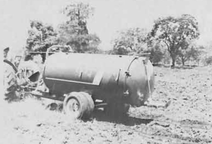
Distribuidor de esterco líquido com capacidade de 4.000 litros
