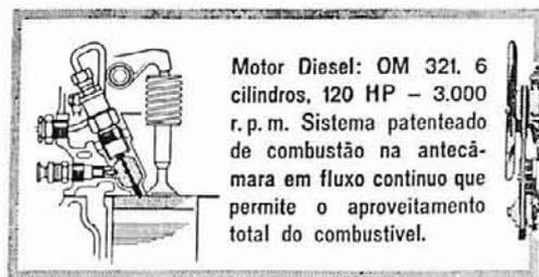
Motor Diesel: OM 321. 6 cilindros, 120 HP - 3.000 r.p.m. Sistema patenteado de combustão na antecâmara em fluxo contínuo que permite o aproveitamento total do combustível.
